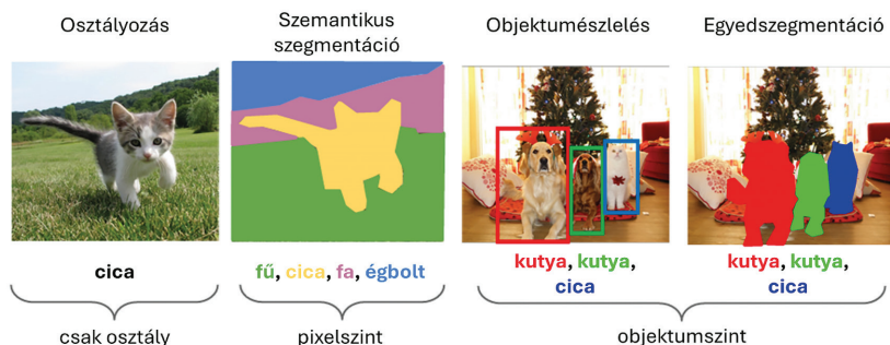
4. ábra: Példák képosztályozási, objektumészlelési, szemantikus szegmentációs és egyedszegmentációs feladatokra 39
