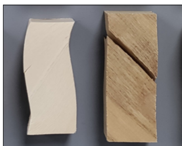
13. ábra. A próbatetek jellemző törésképe – LT45
