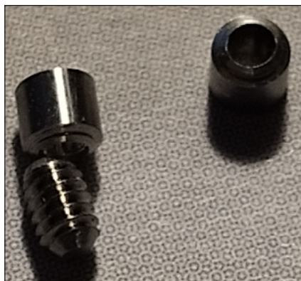
4. ábra. Csavar a tönkremenetel után, két leszakadt csavarfej és egy menetes szár
