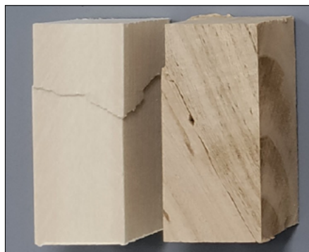
4. ábra. A próbatestek jellemző törésképe – LR0
