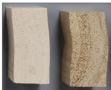
16. ábra. A próbatetek jellemző törési képe – LT90
