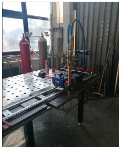
1. ábra. A próbadarabok vágásához alkalmazott lángvágó berendezés
