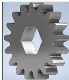
2. ábra. Az alkalmazott, evolvens hengeres fogaskerék Inventor-modellje
