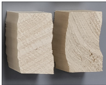
19. ábra. A próbatetek jellemző törési képe – RT45
