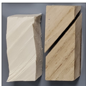
7. ábra. A próbatetek jellemző törésképe – LR45
