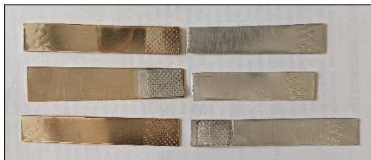
4. ábra. Nagyobb nyomáson hegesztett mintadarabok
