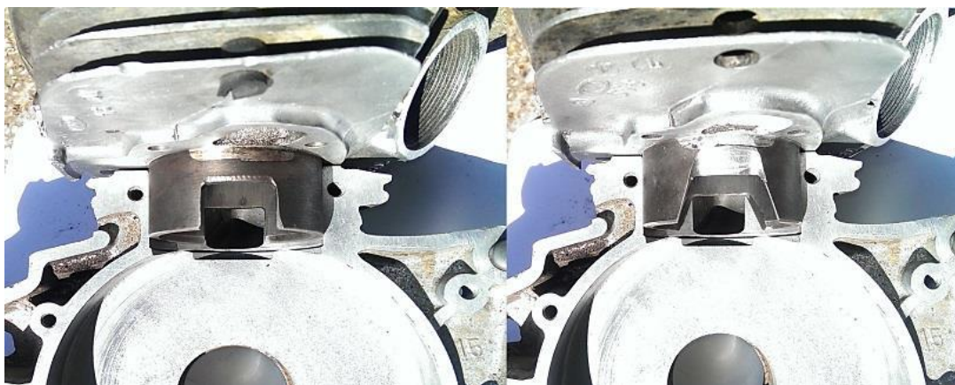
4. ábra A gyári (bal), valamint módosított (jobb) hengerpersely [saját felvétel]
