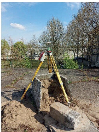
3. ábra. Leica GPS520 vevő a 65-4015 ponton.
