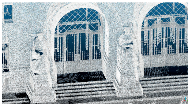
3. ábra A BME Központi épületének homlokzatáról készült TLS-felvétel – részleges takarásokkal, egyenetlen ponteloszlással és hiányos visszaverődésekkel
