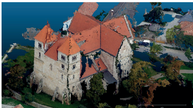
4. ábra Fotogrammetriai rekonstrukció az ócsai templomról kisrepülőgépes légifelvétel alapján – jól láthatók a lyukak a pontfelhőben
