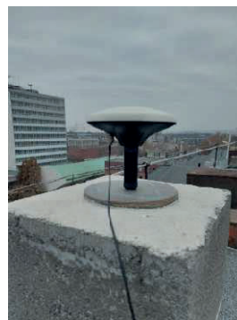
2. ábra U-blox vevővel felszerelt monitor állomások antennái, balra BME D épületén, jobbra a Testvérhegy állomáson
