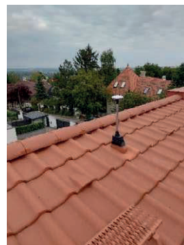
2. ábra U-blox vevővel felszerelt monitor állomások antennái, balra BME D épületén, jobbra a Testvérhegy állomáson
