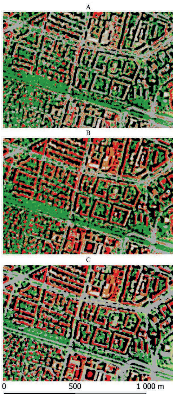
7. ábra. Az alcsoport szerint osztályozások az OSM épületréteg bevonásától függően. A: az 1. módszer szerint az osztályozás külső adatforrás nélkül futott. B: a 2. módszer szerint az osztályozás során az épületpoligonokba eső pixelek csak fém, cseréptető, lapostető és árnyék értéket kaphattak. C: a 3. módszer esetében az épületek a 2. módszer szerint lettek osztályozva, viszont az épület poligonon kívüli pixelek nem kaphattak fém, tetőcserép és lapostető értéket. Jelmagyarázat: 6. ábra
