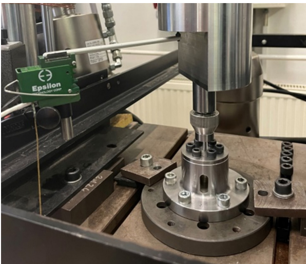
5. ábra: A mini SPT vizsgálati elrendezés elmozdulás méréssel
