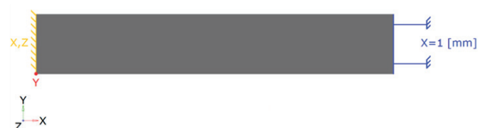
6. ábra: A végelelemes modell peremfeltételei
