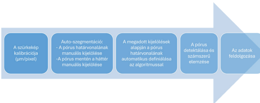
5. ábra: A töretfelületekről pásztázó elektronmikroszkóppal készített felvételek képelemzésének folyamata
