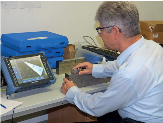
Fázisvezérelt vizsgálókészülék beállítása a miskolci laboratóriumban
