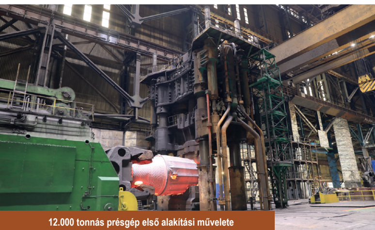
Buga befogása az első kovácsolási művelethez
