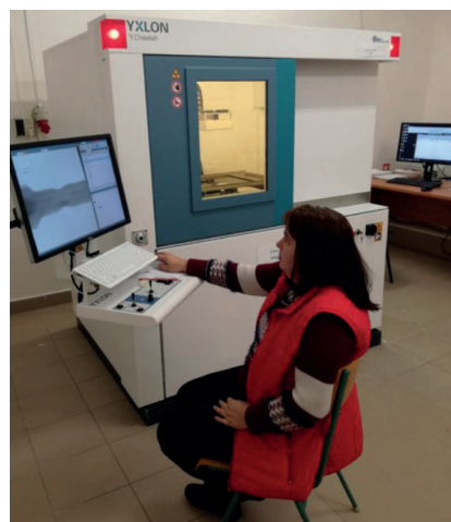
27. ábra: Dr. Fábián Réka vizsgálatot végez az FXE 160.51 típusú multifókuszú röntgen berendezéssel
