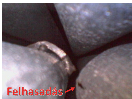
7. ábra: Endoszkópos felvétel a köteg belsejében, a felhasadt burkolatról
