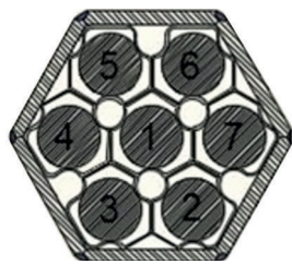
2. ábra: A CODEX-SLIM köteg keresztmetszete
