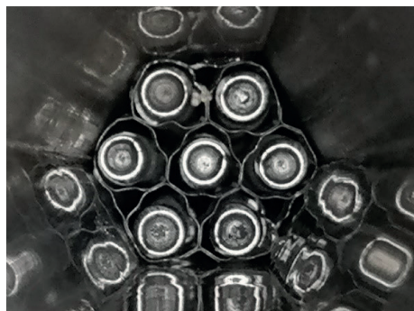
6. ábra: Endoszkópos felvétel a köteg felső részéről
