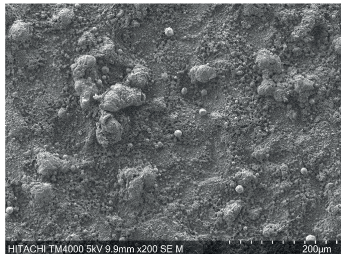
6. ábra: Olvadt fémgyöngyök a vágási felületen
