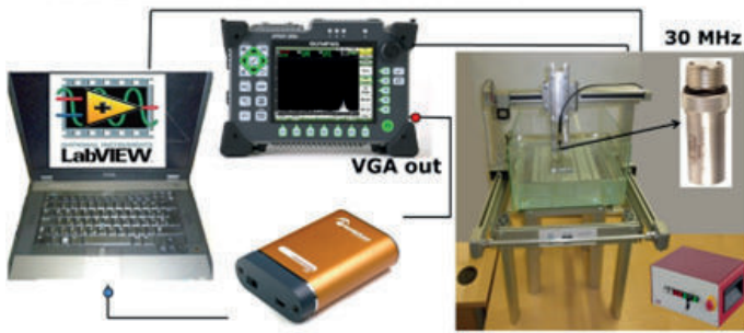
6. ábra: A PAMELA pásztázó akusztikus mikroszkóp, amelyet a DUE-en fejlesztettünk 2012-ben
