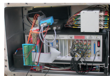
Balra fent: Külső programozható főerősítők, lejjebb a jelkábélbe épített előerősítő; Jobbra fent: 40 AE csatornás, folyamatos monitoring rendszer műszerszekrénye; Alul balra: Teljes kiépítésű, 32-csatornás készülék; Alul jobbra: 16 AE csatornás, folyamatos monitoring rendszer műszerszekrénye
