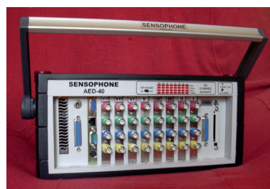
Balra fent: Külső programozható főerősítők, lejjebb a jelkábélbe épített előerősítő; Jobbra fent: 40 AE csatornás, folyamatos monitoring rendszer műszerszekrénye; Alul balra: Teljes kiépítésű, 32-csatornás készülék; Alul jobbra: 16 AE csatornás, folyamatos monitoring rendszer műszerszekrénye
