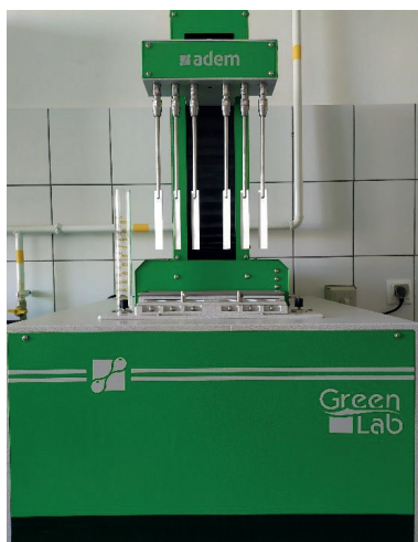
4. ábra: Automatizált módszerrel végzett emulgeáló hatás vizsgálatához használt készülék
