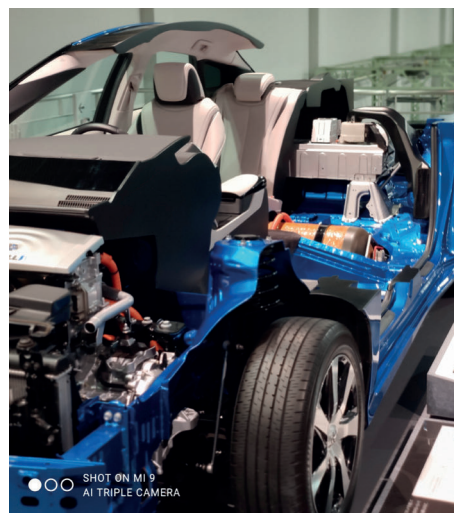
A Toyota Mirai metszete, a kép közepén a sárga tárgy a 700 bar nyomást tartó hidrogén tank
