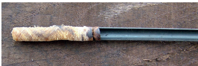
5. ábra: Növedékcsap telített tölgy váltóaljból
