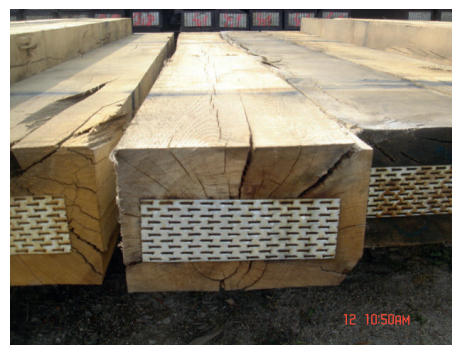
3. ábra: Nem elfogadható gyűrűs elválás a keresztmetszeten
