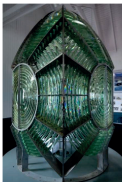
Fresnel lencsés optika és a reflektort mozgó szerkezet [7, 8]
