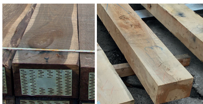
4. ábra: Egészséges göcs telített (balra) és korhadt göcs (jobbra) telítetlen tölgy váltóaljon
