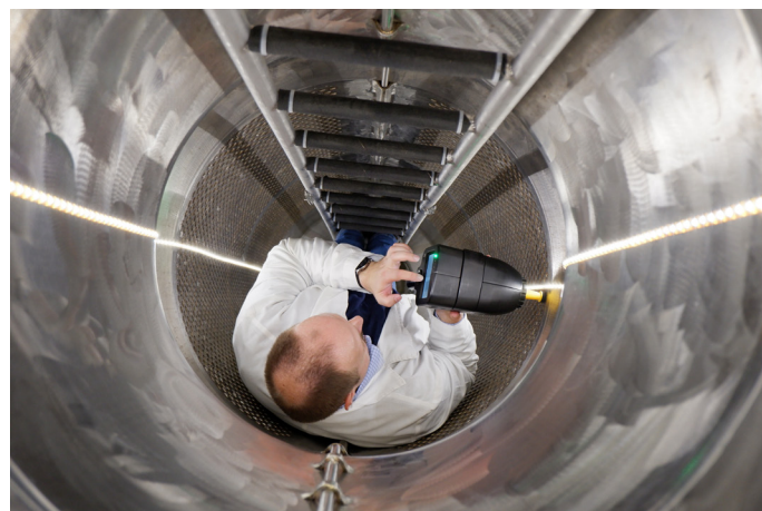
8. ábra: A gőzfejlesztő hőcserélő csöveinek APR vizsgálata
