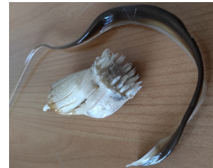
1. ábra: A tömődés és a lakkszerű kiválás a filament gyártása során
