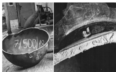
2. ábra: DLE 500 anyagú tartály, bemetszés az alapanyagban, törés -20 °C hőmérsékleten
