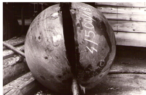
1. ábra: DLE 500 anyagú tartály, bemetszés az alapanyagban, törés -20 °C hőmérsékleten
