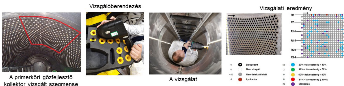
3. ábra: A primerköri gőzfejlesztő hőcserélő csöveinek APR vizsgálata [2]
