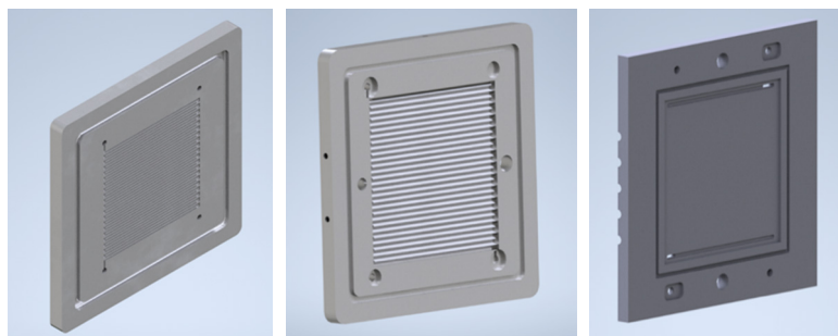
3. ábra: A bipoláris lemez kialakítási koncepciójának fejlődési szakaszai
