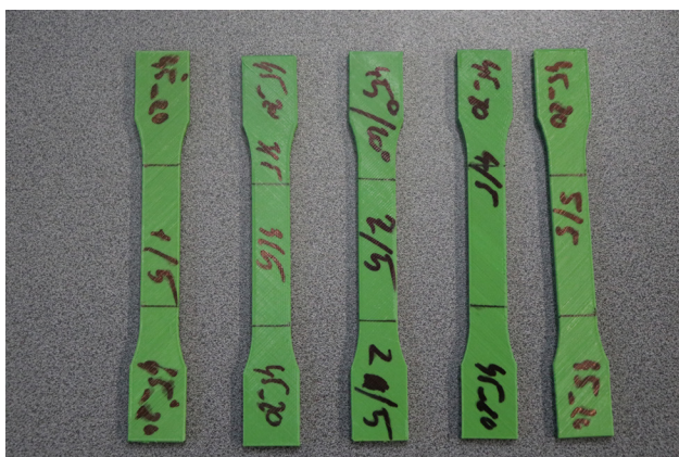
5. ábra: PLA Plus anyagú szakítópróbatetek kezdeti jeltávval ellátva
