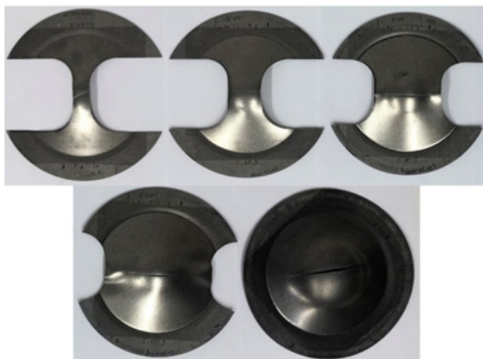
3. ábra: Tönkrementelig alakított Nakazima próbatestek
