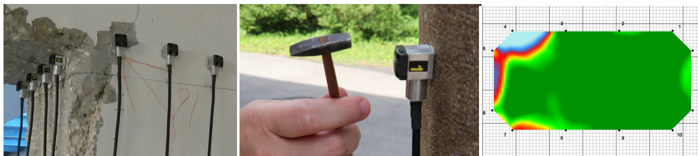
4. ábra: Betonszerkezet mérése. Jobbról balra: érzékelők egy betonoszlopon, mérés, „koppintás” kis (fém) kalapáccsal, és egy oszlop tomogramja. A zöld szín magasabb hangsebességre, míg a sárga, a piros és a kék színek egyre alacsonyabb hangsebességre utalnak
