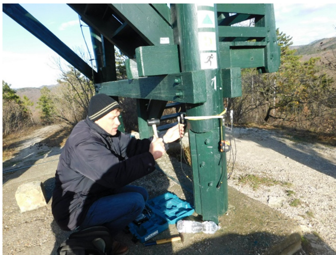
17. ábra: ArborSonic 3D készülék felszerelése az egyik főoszlop lábára
