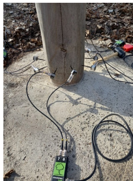
29. ábra: Talajbefogásnál történő akusztikus tomográfias mérés egy kalandparkban
