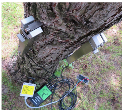
8. ábra: A dinamikus vizsgálat során a megnyúlásmérőket egymástól 90°-ban kell felrögzíteni a mért fa törzsére (azonos magasságban)
