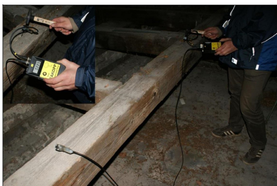
1. ábra: Hangsebesség mérés tetőszerkezetben
