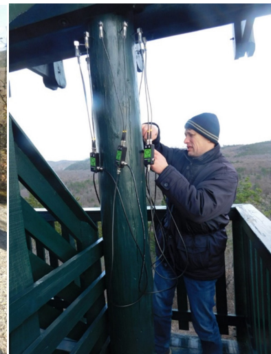
18. ábra: ArborSonic 3D műszer felszerelése az egyik főoszlopra
