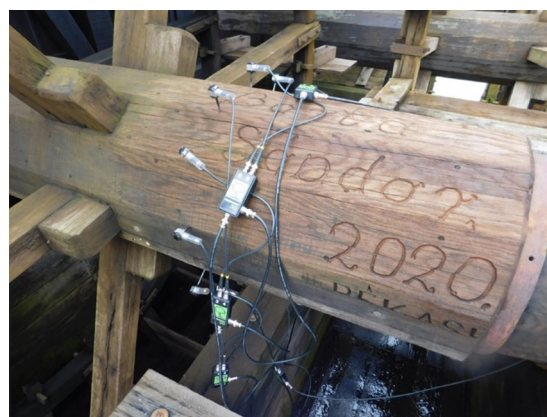
21. ábra: A tengelyre helyezett ArborSonic 3D készülék
