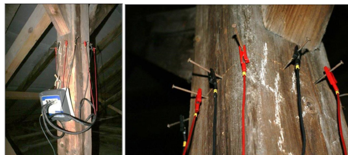
14. ábra: Impedancia tomográfia, balra a központi egység, jobbra az elektródák láthatók
