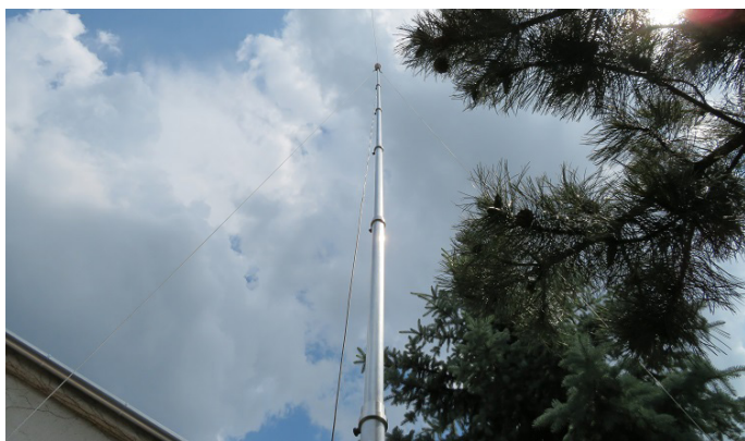
9. ábra: 10 méteres pneumatikus torony, tetején a szélmérővel
