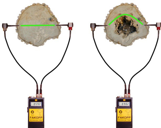
1. ábra: Vonalmenti akusztikus mérés sematikus rajza ép és korhadt fa esetén
