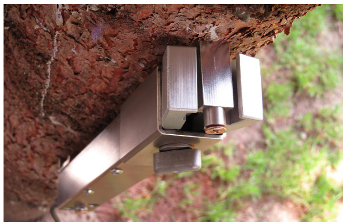
3. ábra: Megnyúlásmérő egy fenyő törzsén
