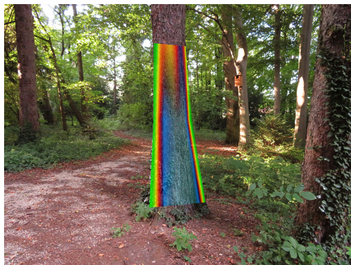
3. ábra: Több magasságban mért tomogramokból interpolációval készült függőleges vetület a vizsgált fa fotójára vetítve
