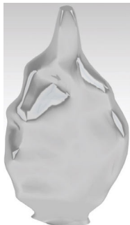
c) kontúrseregekből visszamodellezett szívódási üregek fotorenderelt képe (a, b, c jelű – szívódási üregek esetén)
