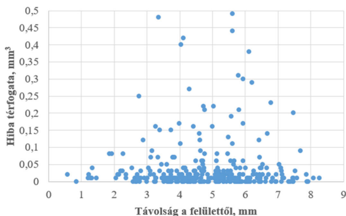
8. ábra: A folytonossági hibák térfogata a felülettől számított távolság függvényében
