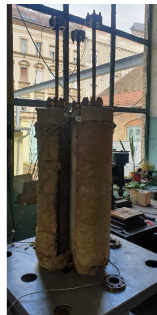
9. ábra: A mérőberendezés felépítése bal: szigetelés nélkül, jobb: első réteg szigeteléssel
