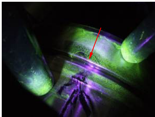
19. ábra: Repedés a spacer külső palástján UV fényben
