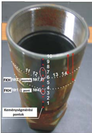
10. ábra: Olajipari menetes fúrócső MMM módszerrel történő vizsgálatának eredményei: a palástfelületen láthatóak a mágneses tér deriváltjának erővonalai, illetve a keményseghmérés pontok (1-től 10-ig)
