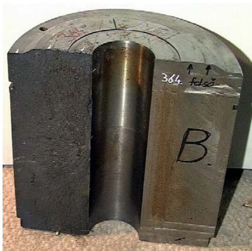
20. ábra: Kettérepedt spacer
