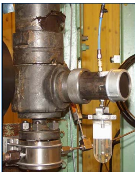
5. ábra: 325 bar nyitónyomású biztonsági szelep tömörség ellenőrzése
