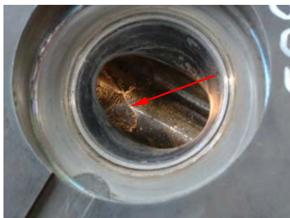
12. ábra: Korróziós anyagfogyás a nagynyomású szelep alsó részén
