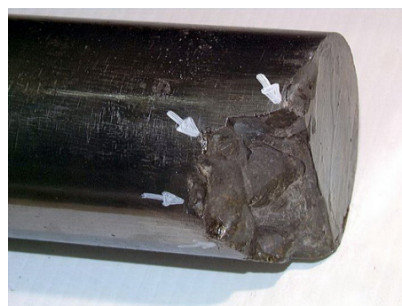
17. ábra: Törött dugattyúrúd töretfelülete
