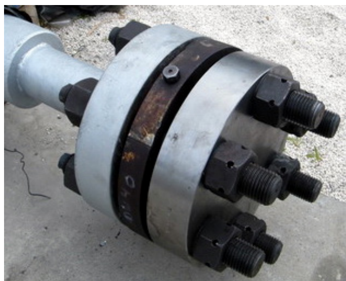
7. ábra: Kötőelemek és lencse összeszerelt állapotban
