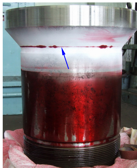
15. ábra: Repedt fedél
