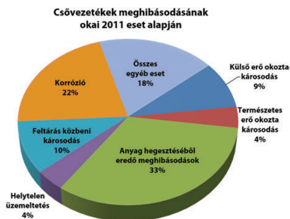
1. ábra. 2011 db meghibásodás okainak megoszlása [7]
