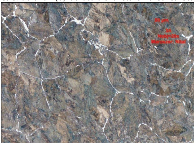
4. ábra. A sín eredeti szövetszerkezete
