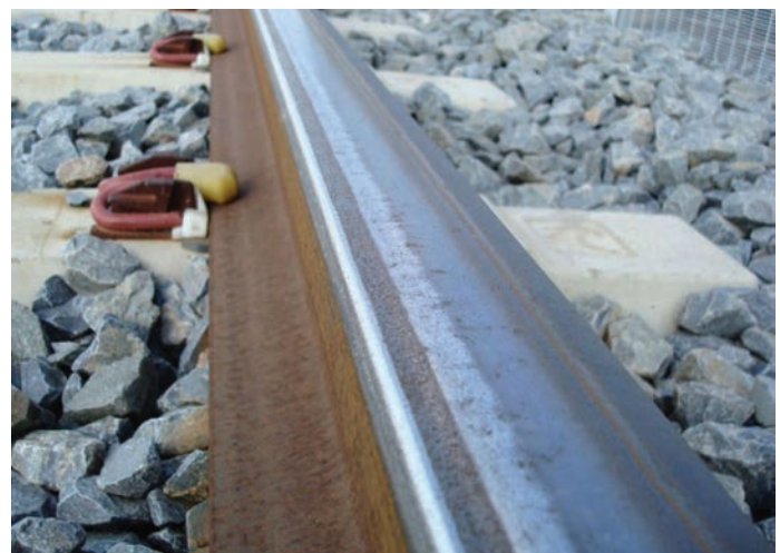
8. ábra. „Head check” károsodási folyamat során károsodott sín korai stádiumban
