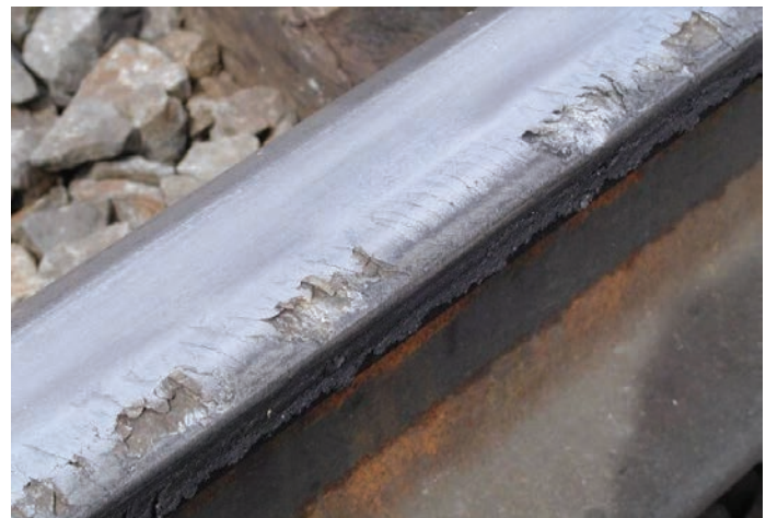
9. ábra. „Head check” károsodási folyamat során károsodott sín előrehaladott stádiumban [9]
