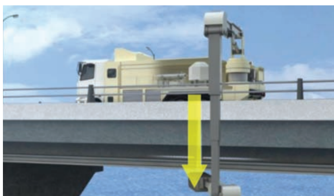
22. ábra. Kompakt neutronforrás nagyfontosságú fejlesztése Japánban - mobil alkalmazásként - hidak, felüljárók vasbeton szerkezeteinek átvilágítására.
