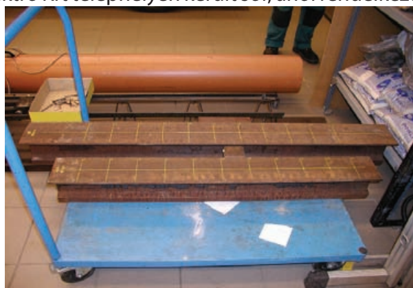
1. ábra: A vasúti sín mágnesezésére szolgáló tekercs, és a mérési pontok elhelyezkedése
