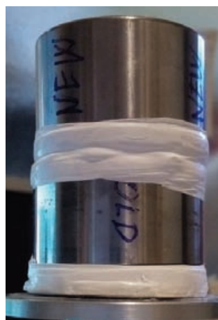
11. ábra. (bal) A vizsgált alkatrész méretei (mm): D = 42 ; d = 20 ; c = 29 ; C = 30 . A csapágyak mérési pozícióban a jobboldali képen: új: felül, használt: alul.
