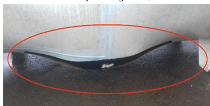
21. ábra A felszakadás a tartály alsó alkotója mentén történt
