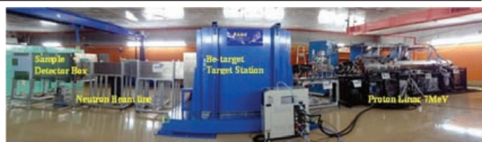
21. ábra. A Tokiói Egyetemen működő kompakt neutronforrás részei: a nyaláb mentén jobbról balra kaladva: 1. ionforrás, 2. protongyorsító, 3. Be-célállomás, 4. neutronnyaláb vezető, 5. minta és detektor egység.
