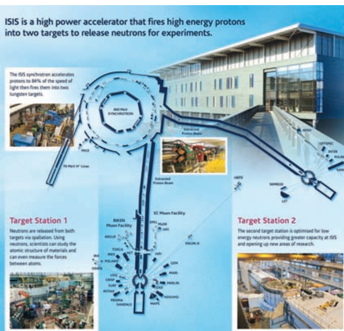
2. ábra. A spallációs források egyik jellemző példája az ISIS ( https://www.isis.stfc.ac.uk ). Az Oxford melletti létesítmény lineáris gyorsítóban előállított és szinkrotron gyűrűben tárolt nagyenergiás proton nyaláb kelt neutron impulzusokat két wolfram target állomásban, melyek egy-egy 50, ill. 10 Hz-es impulzusú target-állomással üzemelő neutronforrásként mintegy 25 spektrométert szolgálnak ki.
