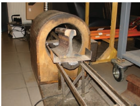
1. ábra: A vasúti sín mágnesezésére szolgáló tekercs, és a mérési pontok elhelyezkedése
