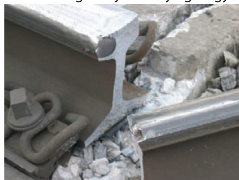
4. kép: Head Check hibából eredő sántörés
