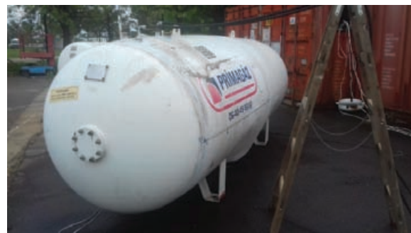
5. ábra: A II/2 sz. tartály (503694). Alul látható a felrepedés
