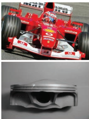
10. ábra. Alumínium ötvözetű dugattyúk nanoszerkezeti elváltozásainak vizsgálata kisszögű neutronsórással a használat különböző stációiban. A jobboldali ábrán a dugattyú felülnézeti képe látható és a képbe beleszerkesztettük az adott helyen felvett 2D SANS intenzitás eloszlás spektrumot, melyből megállapítottuk a precipitátumok méretét és eloszlását. Anizotrop eloszlást és a kiválások előfordulásának erőteljes geometriai függőségét mutattuk ki.
