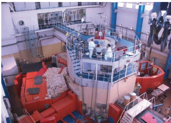
1. ábra. A legfontosabb hazai neutronos bázis, a csillebércei kutatóreaktor (BKR) 1959 óta működik. A BKR-t 1986 és 1992 között felújították, egy 2016-os tanulmány szerint pedig a műszaki állapota valószínűleg lehetővé teszi a reaktor üzemidejének tíz évvel való meghosszabbítását a jelenlegi, 2024-ig szóló engedély után is.
