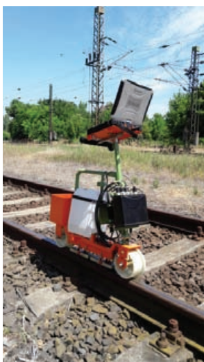
5. kép: Ultrahangos sínvizsgáló kiskocsi
