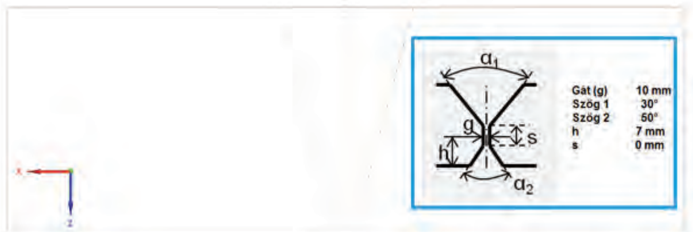
5. ábra A vizsgált hegesztési varrat méretei
