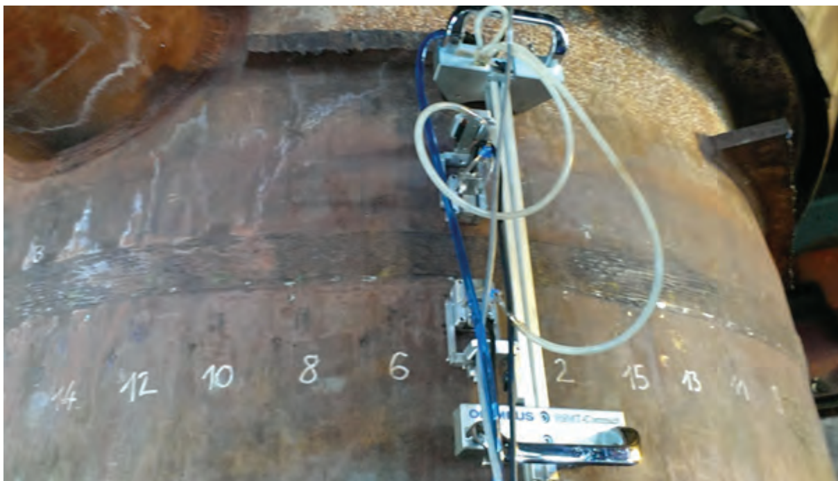
19. ábra A vizsgálati elrendezés a kokszkamra alsó karima varratának esetében
