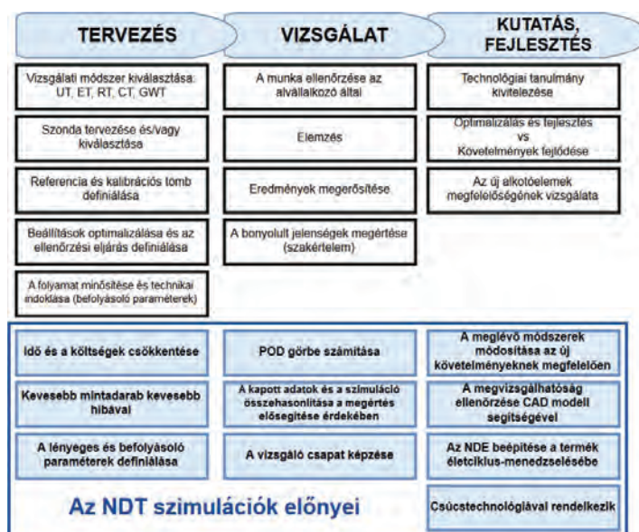
1. ábra A CIVA szimulációk előnyei a vizsgálat különböző szakaszaiban [1]
