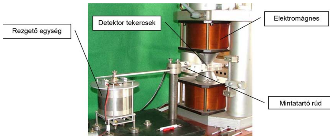
15. ábra A PMVSM berendezés rezgető egysége, rezgő mintatartó rúdja, elektromágnes és a detektor, illetve referencia tekercseket tartalmazó egység.
