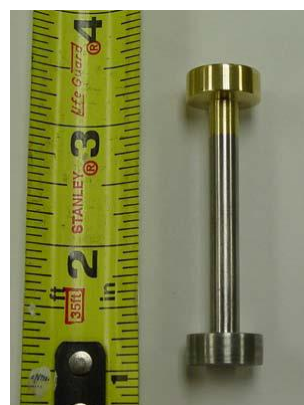
3. ábra A szakító próbatest méretei [5]
