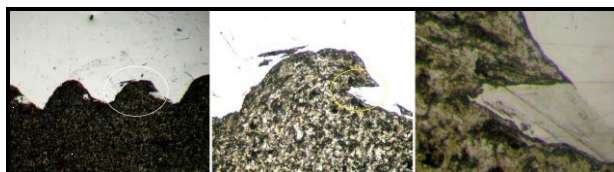
13. ábra: Az S235J2 / 1.4541 lemezpár közti kötés részlete balról jobbra 80x-os, 250x-es és 800x-os nagyításban. Megfigyelhető a jellemző hullámalak, maratás Nitallal [7]
