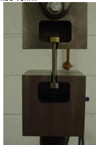
2. ábra Plattírozott lemezből kimunkált szakító próbatest vizsgálata [5]
