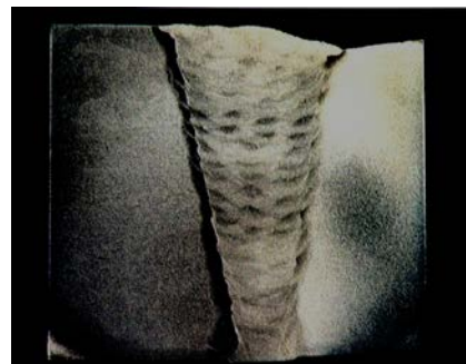
21. ábra. Az eljárásvizsgálathoz készült próbadarab makro-csiszolata
