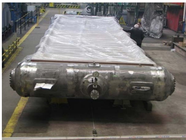
2. ábra Fűtőpatron. A tetején a perforált lemez nem látható a fóliatakaró miatt.
