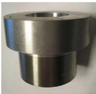
5. ábra Koronaszakító vizsgálat próbatest [6]
