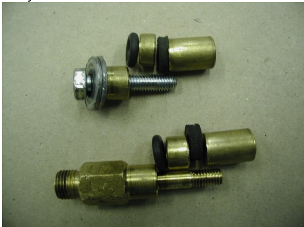
12. ábra. Nyomásos vizsgálat speciális dugói
