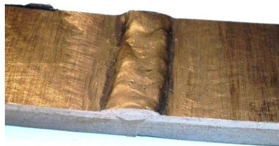
15. ábra S235J2 / 1.4541 Plattírozott lemezek összehegesztése [1,9]
