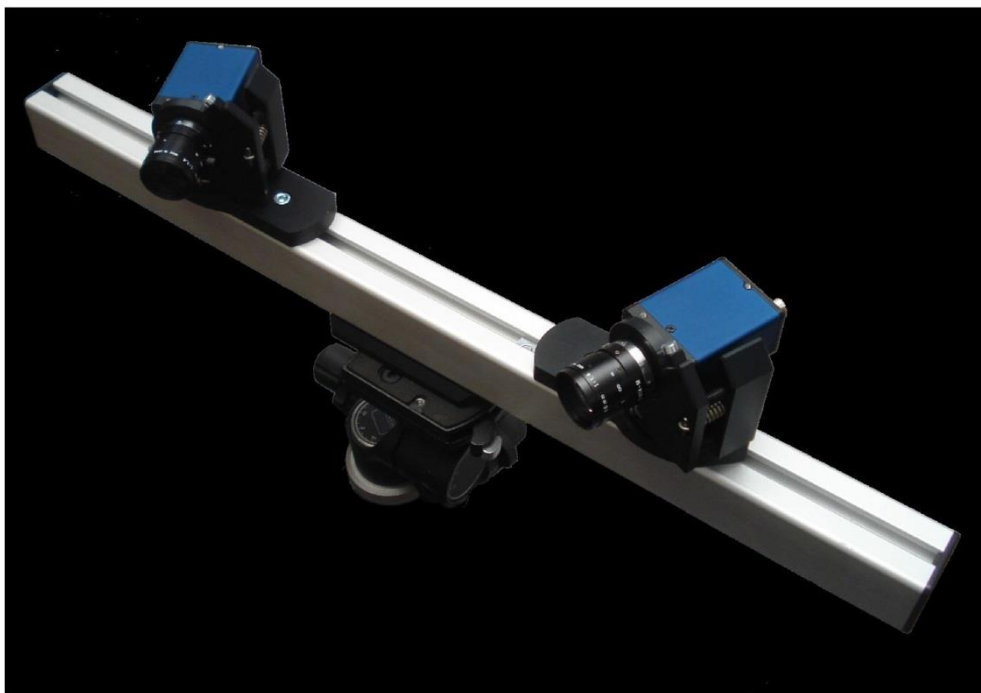
2. ábra. A VIC-3D rendszer főbb elemei [7; 8]
