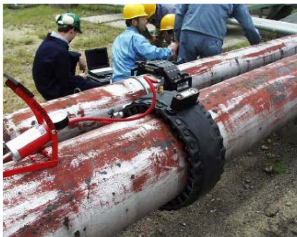
13. ábra. LRUT alkalmazások: gázvezeték és offshore szerkezet.
