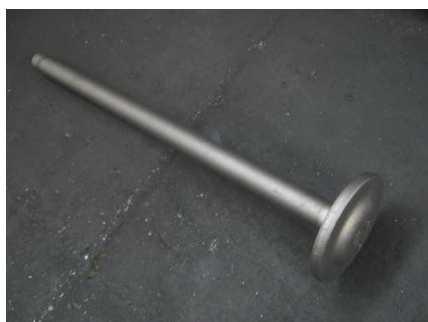
5. ábra: Féltengely UH vizsgálattal kimutatott belső repedése
