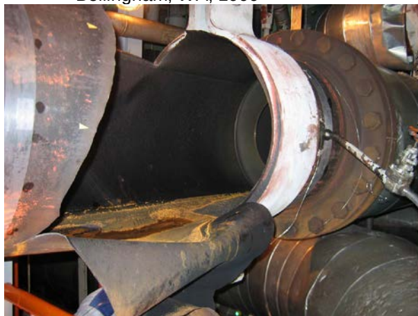
4. ábra. Atomerőmű tápvízvezeték felszakadása, Mihama, Japán, 2004
