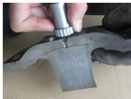
5. ábra: Féltengely UH vizsgálattal kimutatott belső repedése
