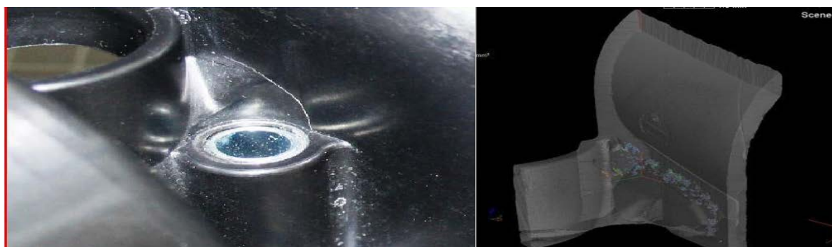
2. ábra: Kompozit ház hiba okának elemzése
