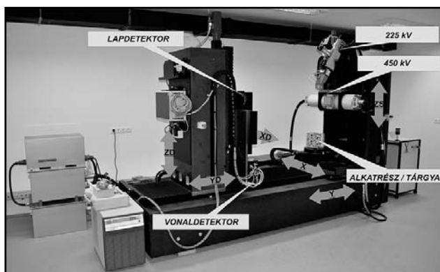
2. ábra. Az YXLON Y.CT Modular ipar CT berendezés funkciói
