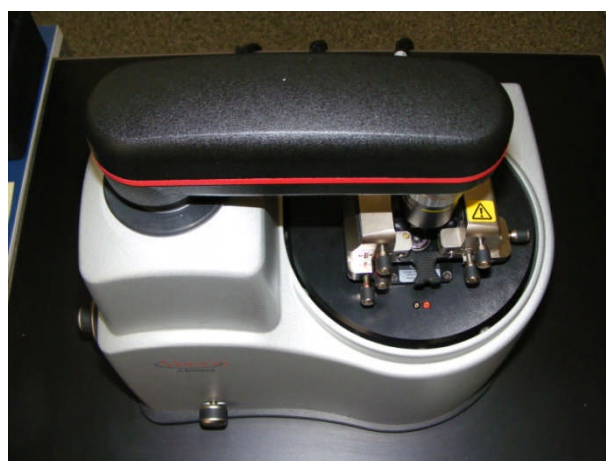
5. ábra Az AFM optikai egységének sematikus vázlata [8]; Veeco dilnnova multi-purpose SPM Figure 5 Schematic of laser reflection in AFM optical unit [8]; Veeco dilnnova multi-purpose SPM
