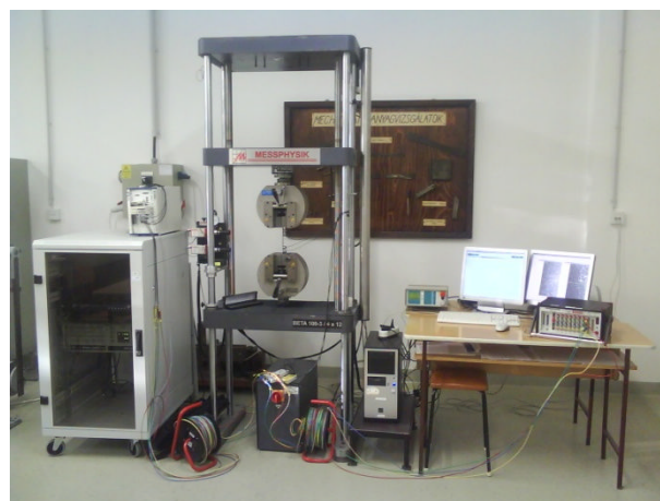
2. ábra A Béta 100- szakítógép az AED-40 és a beágyazott számítógépes rendszer
