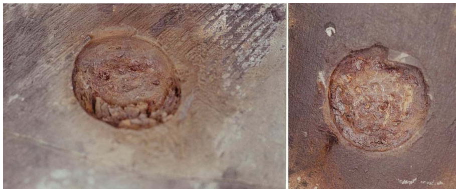
4. ábra Szemmel láthatóan vas korróziós termékek (huzató szegek végei a szobor felületén)
