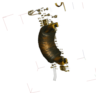
8. ábra. Árammérő szonda képe és a mérőtekerics kiemelése
