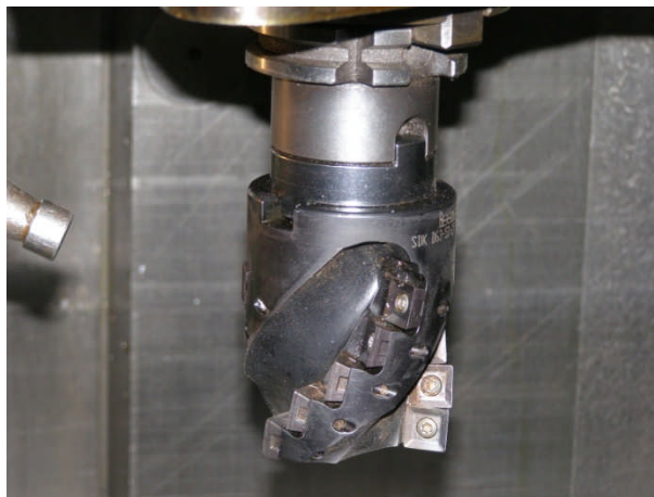
4. ábra Szerelt lapkás kukorica maró
