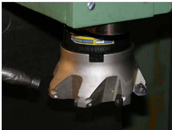
5. ábra Szerelt lapkás alakos homlokmaró
