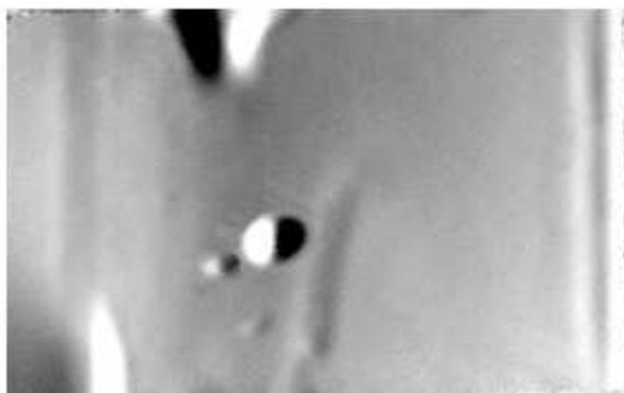
10. ábra. Kompozit repülőgép szerkezet belső hibái (elválások a fémhab mag és a burkolat között).
