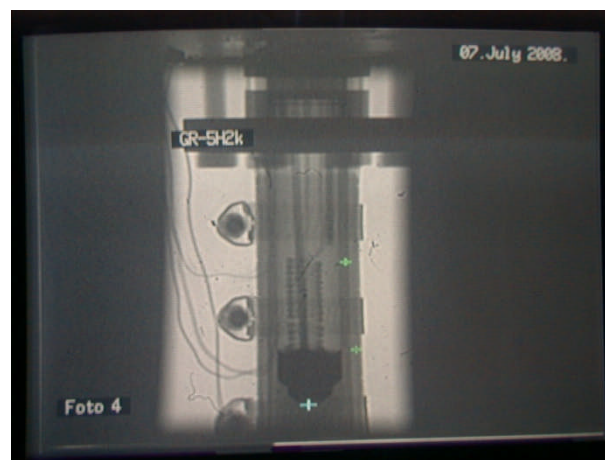
10. ábra A vissza kondenzálódott maradék víz DNR képe 25 C°-on
