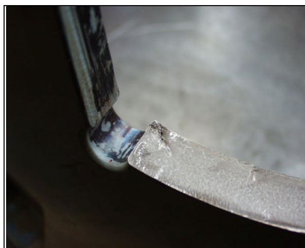
4. ábra – Folytonossági hiányt „sejtető” elváltozás Fig 4. – Defect indicating discontinuity
