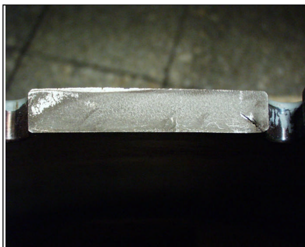
5. ábra – Kifáradási folyamatra utaló törésselület Fig 5. – Fracture surface indicating fatigue process
