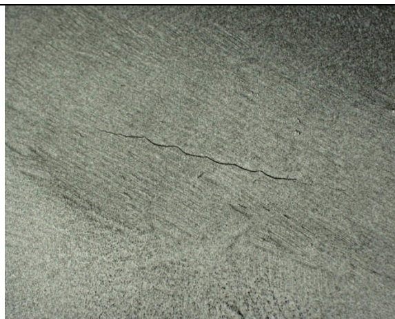
1. ábra – Tartály belső falán roncsolásmentes eljárással feltárt indikáció Figure 1 – Indication found by NDT on the inner surface of a vessel
