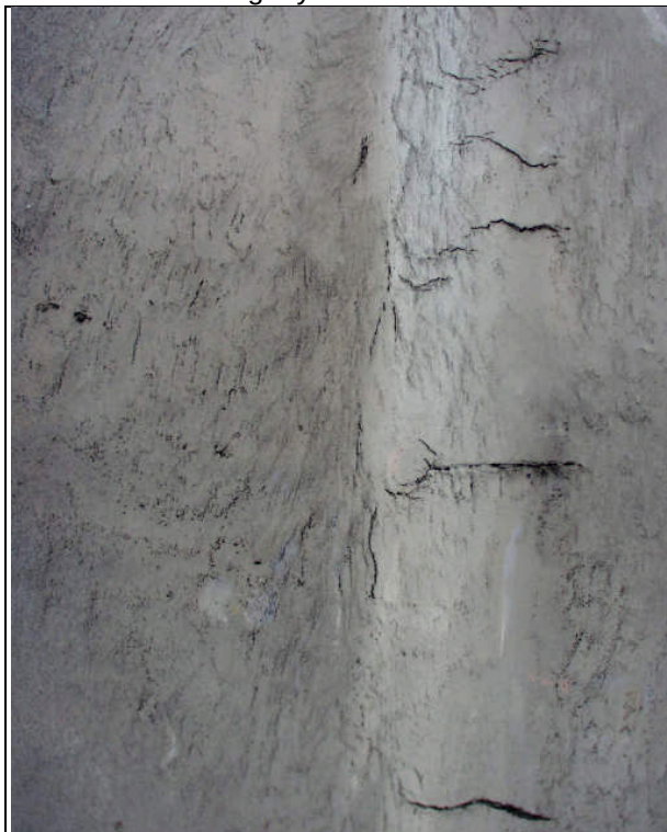
11. ábra – Repedések egy gőzvezeték hegesztési varratában (N \approx 1x) Fig. 11. – Cracks in the weld of a steam pipe (M \approx 1x)
