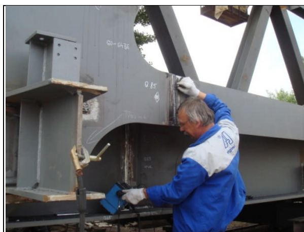
3. ábra Helyszíni roncsolásmentes anyagvizsgálat az épülő új Duna hídon Figure 3 NDT of the new Danube bridge part on site
