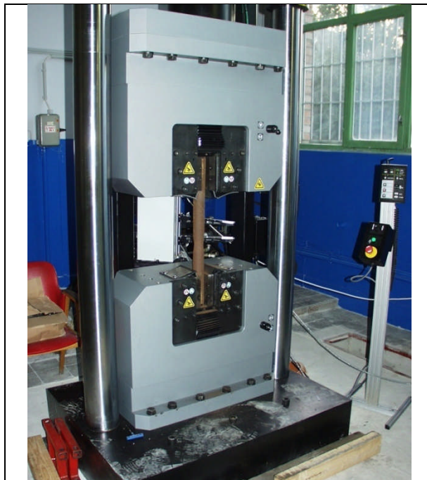
1. ábra Az ország egyik legnagyobb, 1500 kN kapacitású szakítógépe működés közben Figure 1 One of the highest 1500 kN capacity tensile testing machine of Hungary in operation
