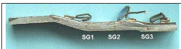
Fig.7: Tube thickness on longitudinal cut 7. ábra Cső falvastagsága hosszirányú vágásnál
