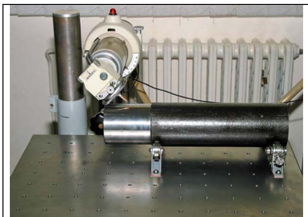
Fig. 3 Measurement of axial residual stresses \sigma_a on the turned surface of investigated samples 3. ábra Az axiális visszamaradó feszültség mérése a minta esztergált felületén
