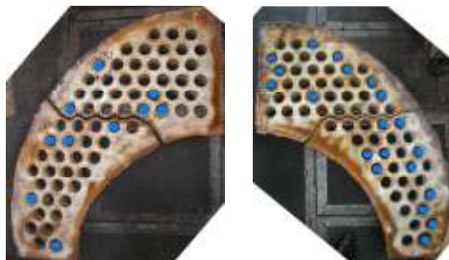
3. ábra. A kivágott hátsó csőfal; kékkel jelöltük a hibás csővégbehegesztéseket
