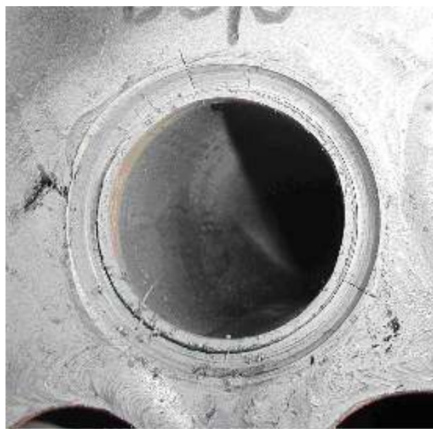
2. ábra. Egy kimart varrat az ismételt repedésvizsgálat után
