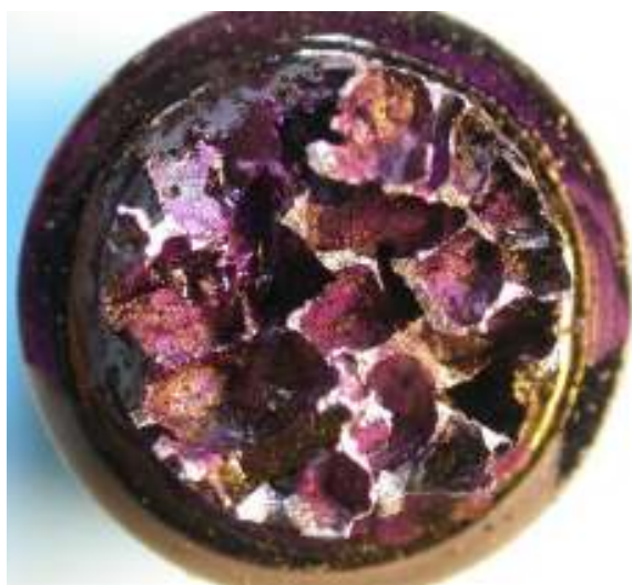
9. ábra. Nyílt cellás szakító próbatest töretfelülete
