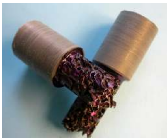
8. ábra. Nyílt cellás próbatest a szakítás után
