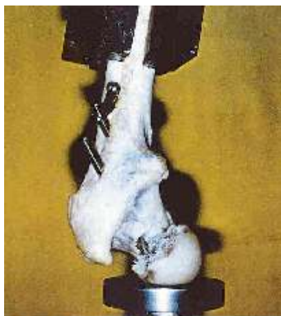
4. ábra. Csavarokkal rögzített combnyak-törés vizsgálata Fig. 4: Testing of a fractured femoral neck fixed by screws
