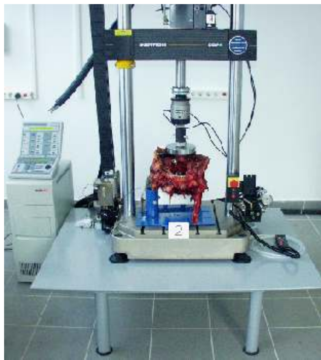
8. ábra. Belül rögzített törött medence vizsgálata Fig. 8: Testing of a fractured hip bone fixed inside
