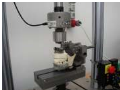
5. ábra. Alsó állkapocs és fogprotézis vizsgálata Fig. 5: Testing of a mandible and tooth prosthesis
