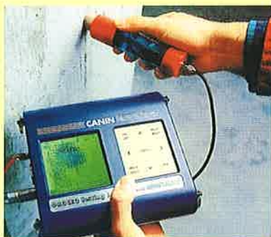
CANIN a betonba ágyazott vas korróziójának feltérképezéséhez
