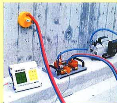
TORRENT permeabilitás mérő a fedő betonréteg minősítéséhez
