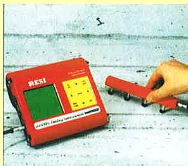
RESI ellenállás mérő a korróziós károsodás felderítéséhez
