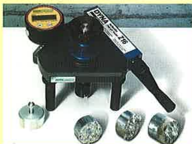
DYNA kötésvizsgáló kézi készülék a fedőréteg, a bevonat felületi szilárdságának méréséhez
