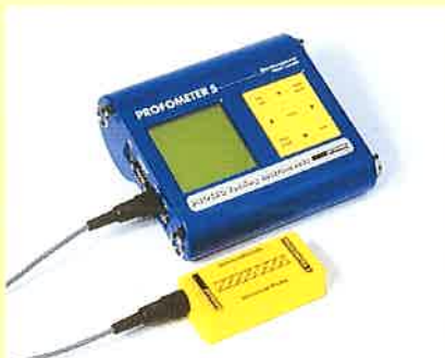
PROFOMETER 5 a betonvas helyének és méretének beméréséhez
