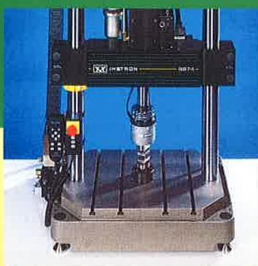
szerkezetvizsgálat biaxiális terheléssel
