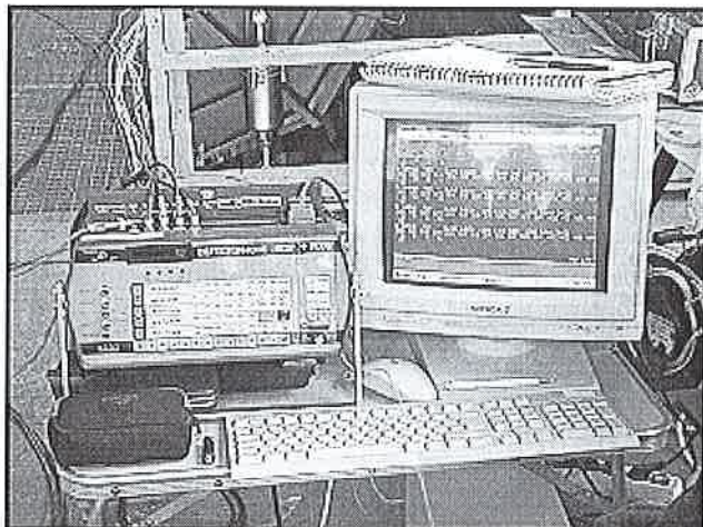
1. ábra. Defectophone NEZ-220 típusú mérőkészülék négy csatornás kiépítésben
