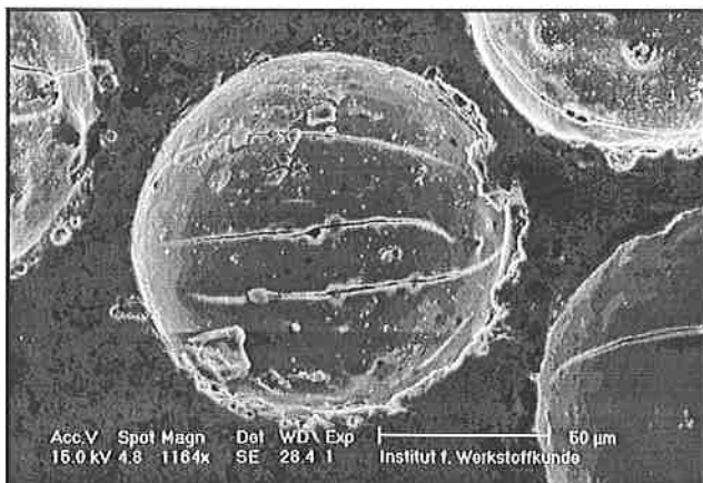
13. ábra. 8% alakváltozásnál a nagy alakítási fok csak a csúszósík környezetére koncentrálódik. Attól távolabb kisebb alakítási fok
