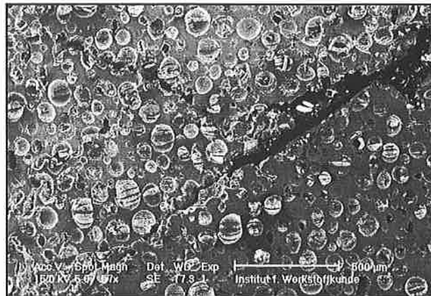
14. ábra. 12% alakváltozásnál megindul a repedésképződés a nagy repedésre merőleges irányban is
