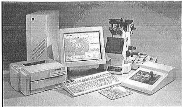
1. ábra. Az OMNIMET képfeldolgozó rendszer mikroszkóppal, motorikus mozgatható tárgyasztallal és nyomtatóval
