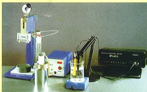
IK A ADD 1 kén- és halogénmeghatározó készülék
