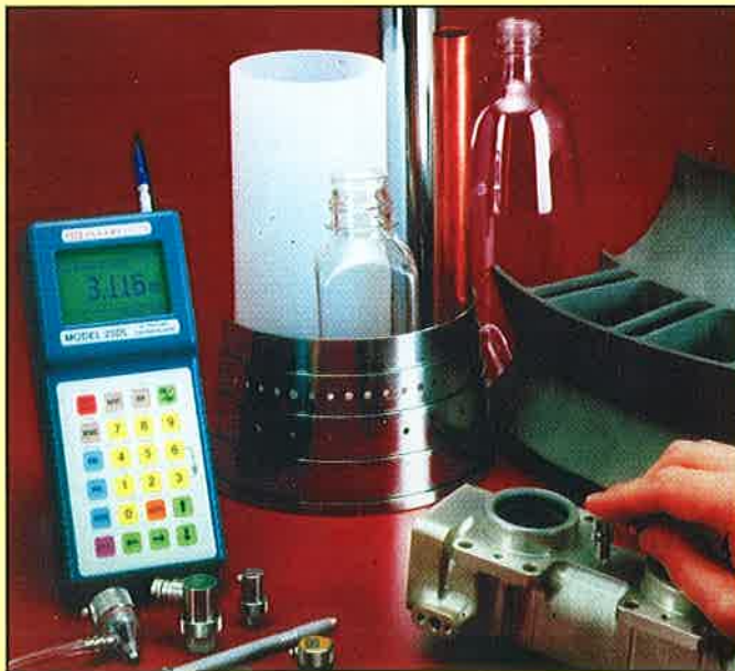
25 DL precíziós vastagságmérő már 0,1 mm-től, fémre, műanyagra
