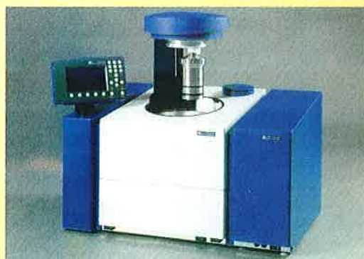
IK A C 5000 típusú kaloriméter
