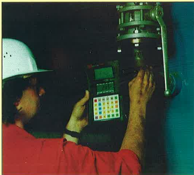
26 DL Plus korróziómérő hőálló fejjel, 500 °C-ig
