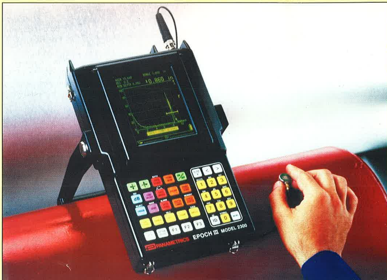
Epoch III kézi „nagy” készülék: A-képpel ellenőrzött vastagságmérés, bevonat-korrektció – közvetlen leolvasás – adattárolás – határérték-riasztás
