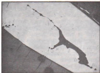
3. ábra Lézer kráterek a keresztmetszetben lyuk és repedés mentén (201 jelzésű minta, N = 25x, kicsinyítés: 0,5x)
