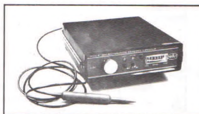
3. ábra A Testor Bt. által gyártott MHK 4 típusú örvényáramos készülék
