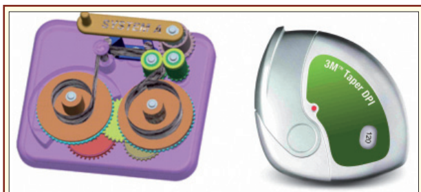
5. ábra: A mikrostrukturált hordozószalag technika sematikus ábrája (bal) és a 3M Taper™ DPI eszköz képe (jobb) [18]
