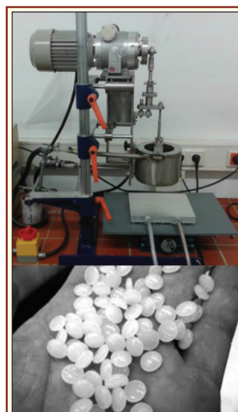
1. ábra: Paracetamol tartalmú pasztilla előállítása „in situ coating” eljárással
