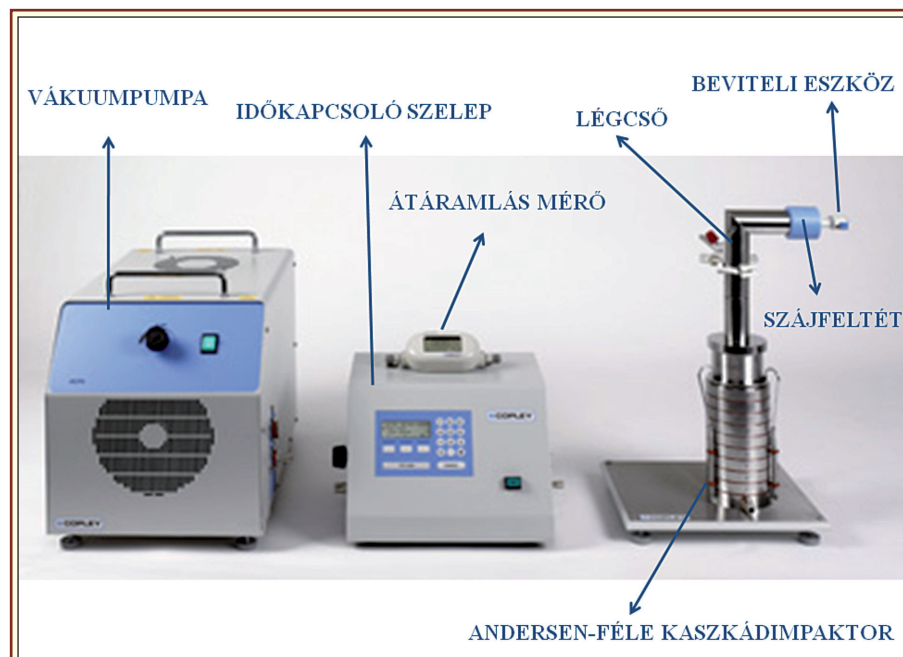
9. ábra: A függőleges elrendezésű „D” jelzésű Andersen-féle kaszkád impaktor. Elrendezése a humán légző traktus felépítésével összevethető [45].
