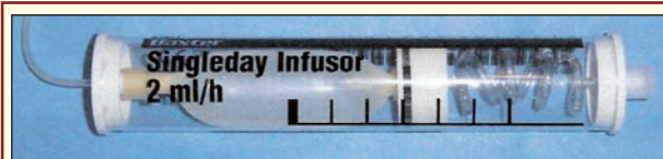
7. ábra: 500 ml-es Infusor típusú kalibrált elasztomer pumpa, filterrel [22]
