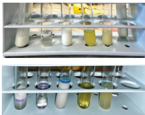
5.A és 5.B ábra: Az egyes mintákban kimutatott fehérjék jelenléte a biuret-reakció előtt és után: tejfölből, zselatin, tej, alma, keksz. Az almában és a kekszben minimális mennyiségű fehérjét sikerült kimutatni, míg a tej, tejfölből és zselatin mutatott színreakciót.
