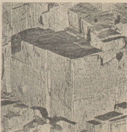
10. kép. Sósavval étetett aluminium elektro- mikroszkópi képe Nagyítás 85000x.
