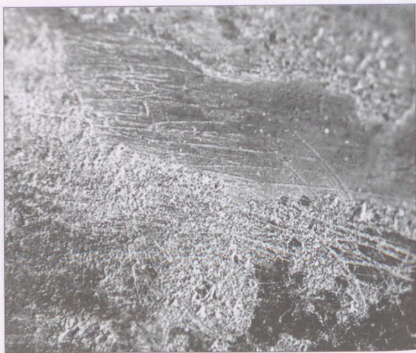
8. ábra. A durva csiszolás nyomai a felületen Figure 8. Signs of rough burnishing on the surface
