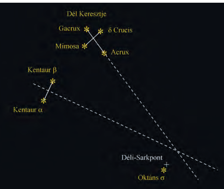
6. ábra: A déli égbolt Déli-Sarkpontjának vizuális meghatározása a Dél Keresztje csillagkép, valamint a Kentaur \alpha , \beta és az Oktáns \sigma csillagok alapján. (A szerzők grafikája)
