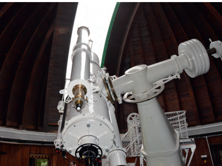
A kupola főműszere egy 60 centiméter tükörátmérőjű Zeiss-Heyde távcső (Fotó: Trupka Zoltán)
