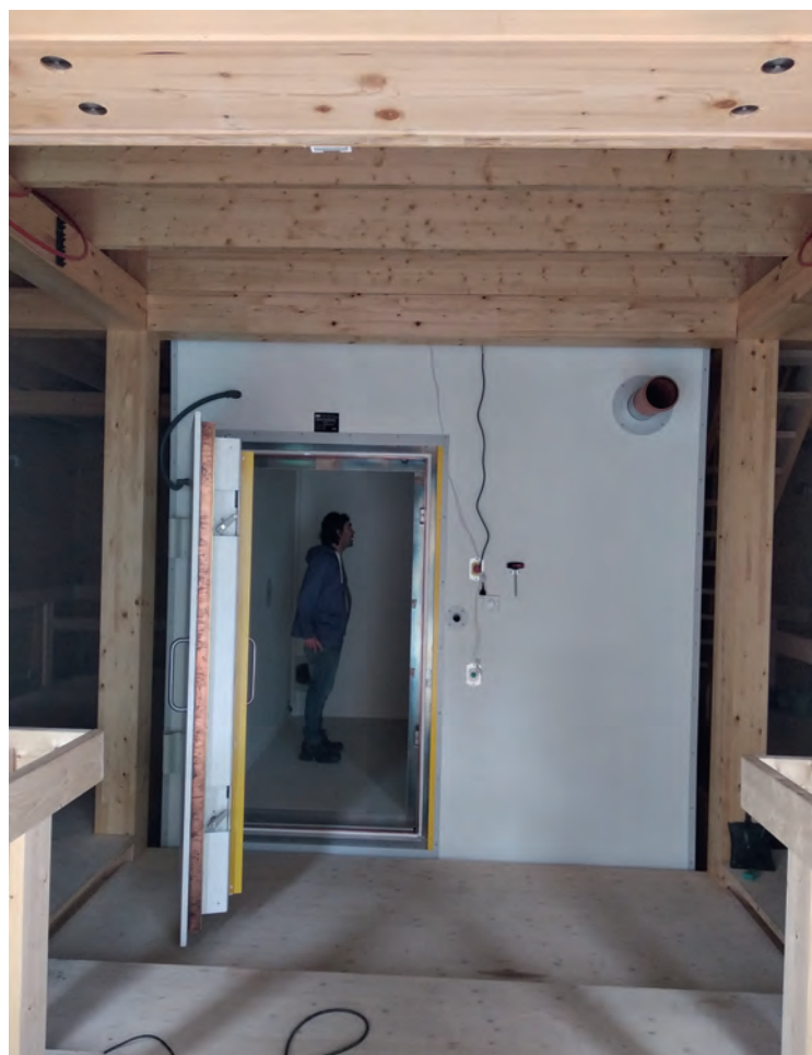
3. ábra. A mágnesesen árnyékolt laboratóriumi szoba
